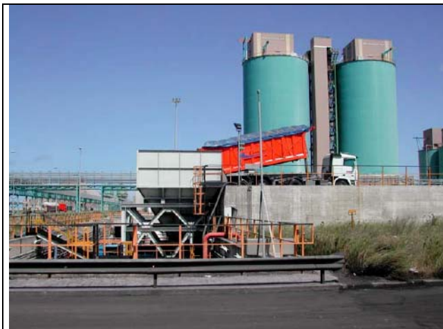
Trasferimento del carbone dall'automezzo al nastro afferente le caldaie mediante le tramogge N22-N23
