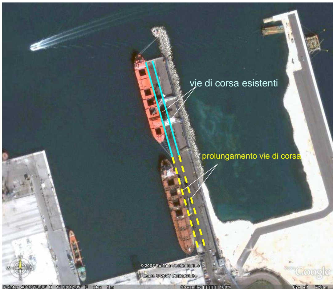
Fig. 4 – Schema del prolungamento delle vie di corsa degli scaricatori
