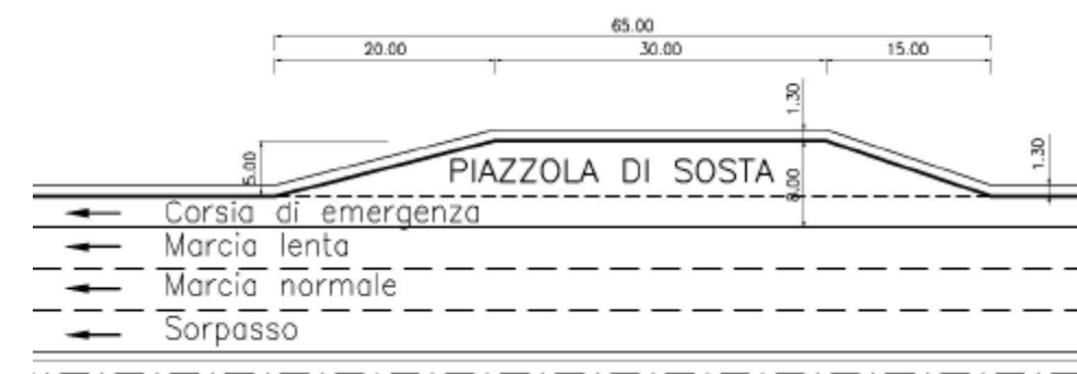
Figura 2-4 - Piazzole di sosta in rilevato/trincea
