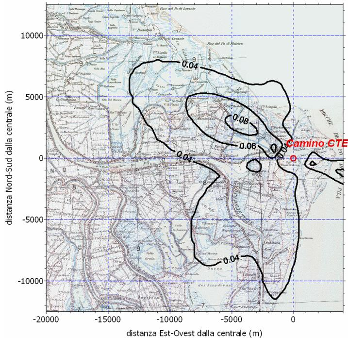
**Figura 3-II Concentrazione giornaliera di SO<sub>2</sub> superata per 3 giorni/anno (percentile 99.1781), configurazione 3GR (alto) e 3GREC (basso).**
