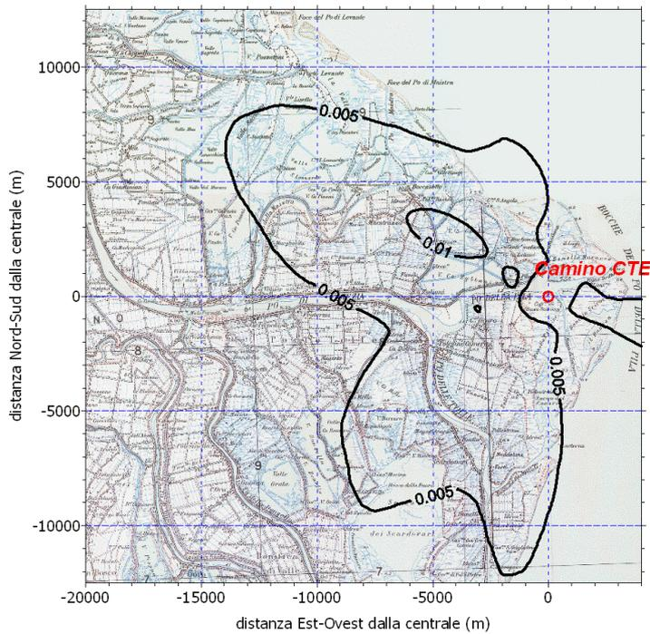
**Figura 3-VIII Concentrazione giornaliera di PM<sub>10</sub> superata per 35 giorni/anno (percentile 90.4110), configurazione 3GR (alto) e 3GREC (basso).**
