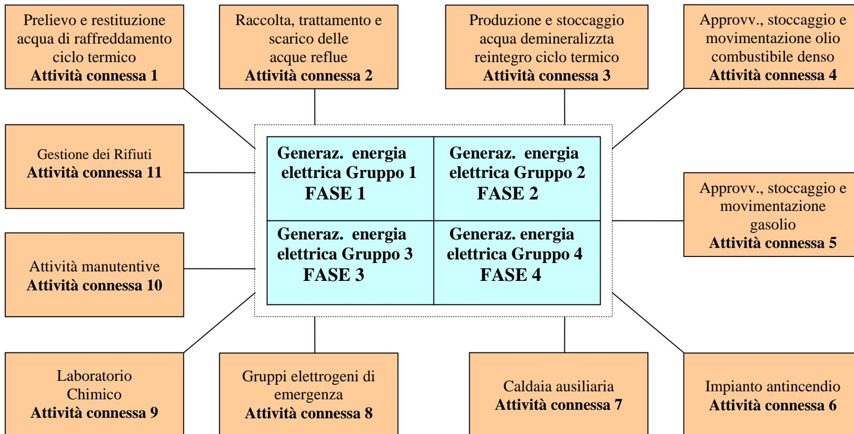
**A.25 – Schema a blocchi delle fasi e delle attività tecnicamente connesse (attività ausiliarie) dell’impianto di Piombino**
