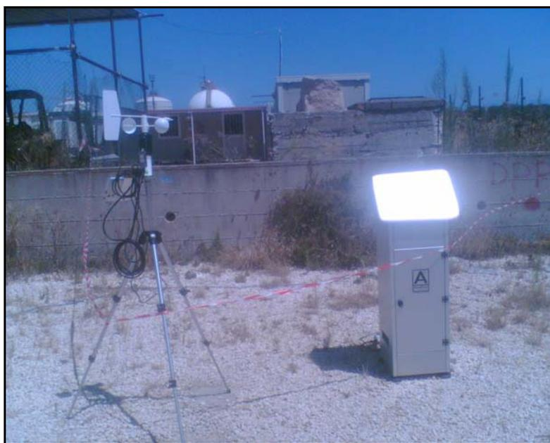
Fig. 16: Esempio di campionamento di diossine eseguito secondo il metodo EPA TO 09 A 1999 in area Syndial utilizzando una pompa ad alto flusso (dx).
