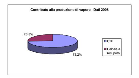
Si può osservare come, pur in presenza di un contributo della CTE largamente predominante alla generazione di energia termica sotto forma di vapore nello stabilimento, anche le caldaie a recupero forniscano un significativo apporto, pari a circa il 27% del totale nel 2006.
