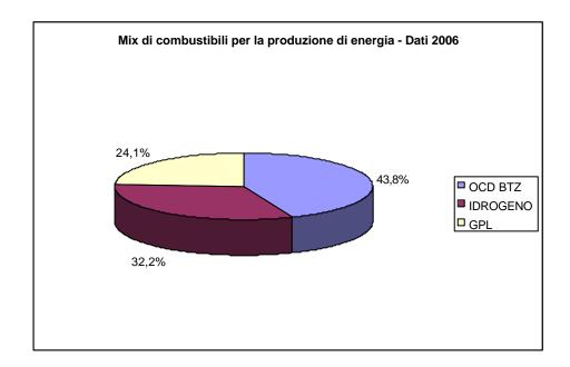
Per quanto riguarda la CTE, il mix di combustibili in ingresso, in termini di contributo alla generazione di energia, è il seguente:
