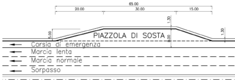
Figura 8-5: - Piazzole di sosta in rilevato/trincea
