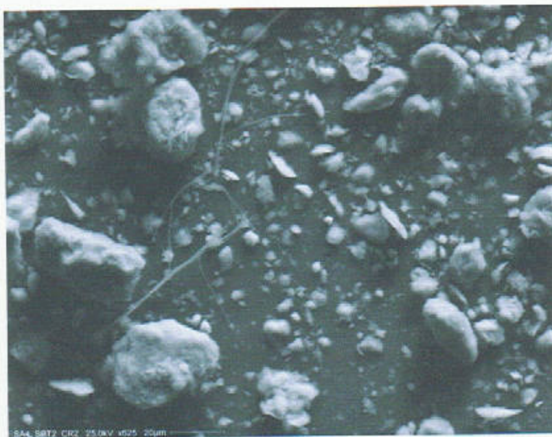
B Microfotografia SEM. Dettaglio del campione analizzato. Granuli litici e fibre di crisotilo.
