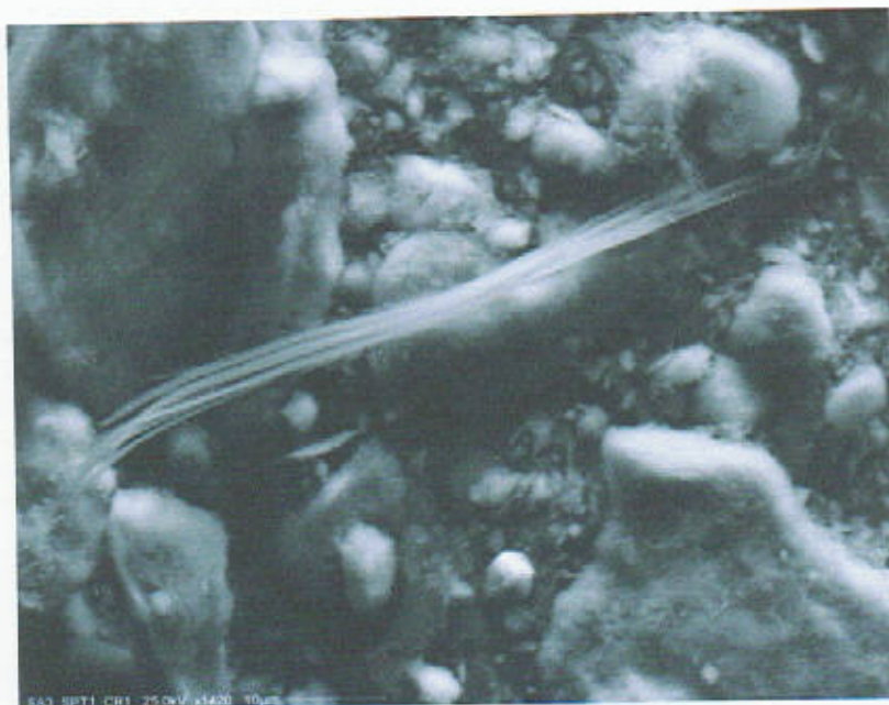
A Microfotografia SEM. Granuli litici e fibre di crisotilo.
