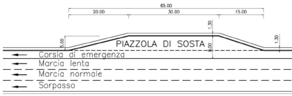
Figura 9-5 - Piazzole di sosta in rilevato/trincea
