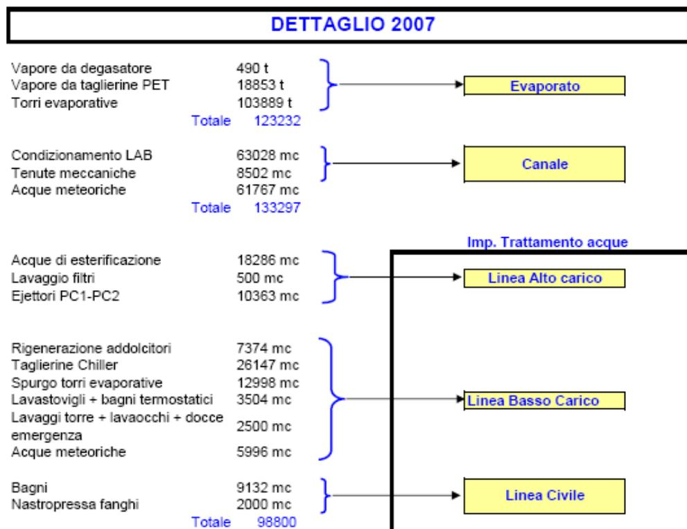
**QUANTIZZAZIONE FLUSSI – DETTAGLIO (ALLA CAPACITÀ PRODUTTIVA)**
