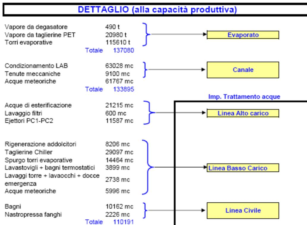
Per quanto concerne i numeri riportati sopra e nell'allegato "Descrizione fase A-25-07 -utilizzo acqua di pozzo" (riportato in: scheda A.25 - richiesta n.19 - ALLEGATO 4), si precisa che le seguenti portate sono misurate mediante mass flow:
