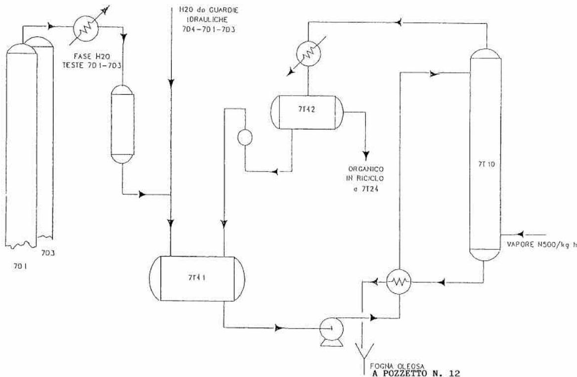
**Figura 7-4: Impianto di strippaggio cicloesano/cicloesano**
