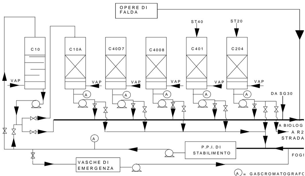
**Figura 7-6: Collettamento reflui a colonne ecologiche e biologico**
