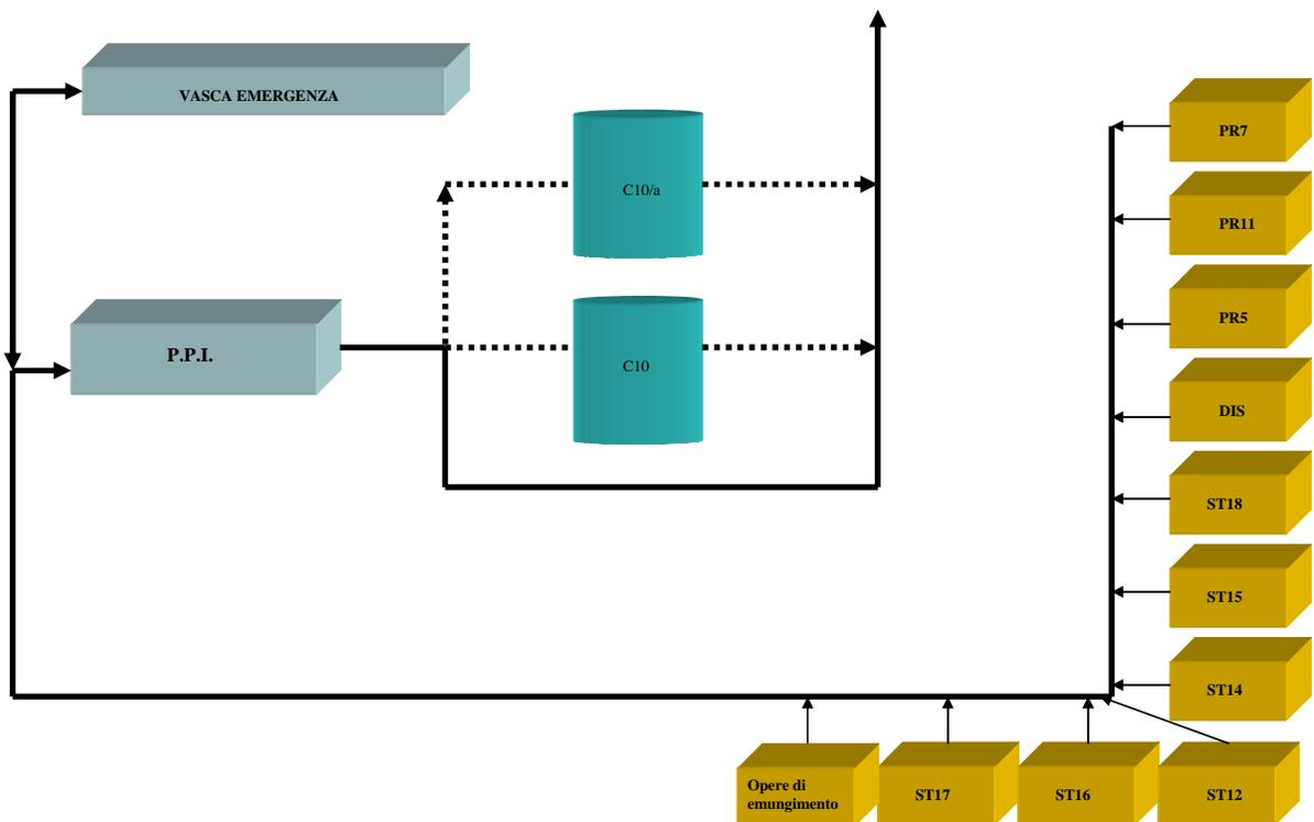
**Figura 6-7: Schema semplificato della fognatura oleosa**
