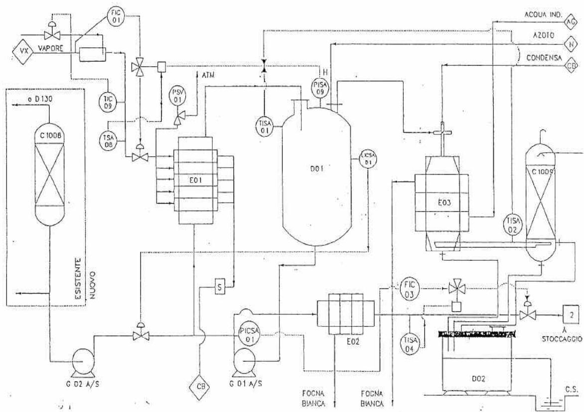
Figura 7-1: Impianto di recupero soluzione tricloruro di alluminio
