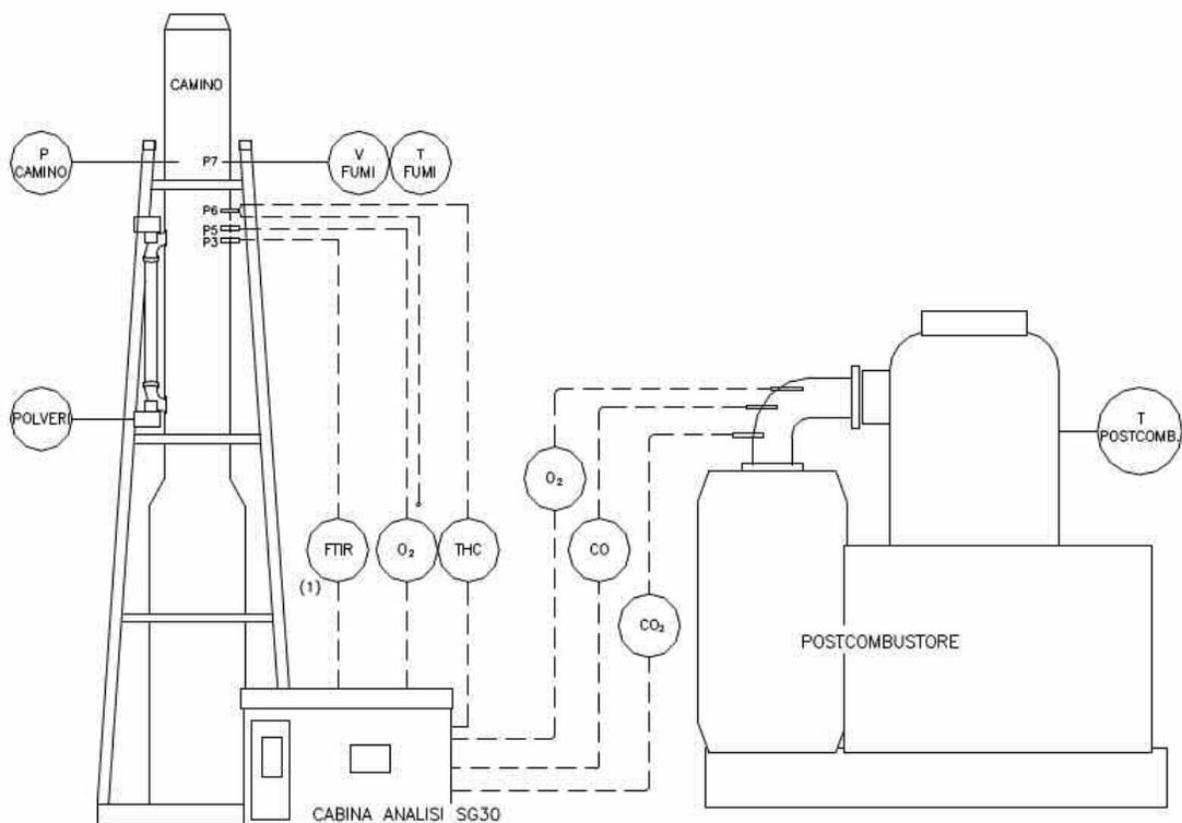
NOTE: 1) FT-IR PER ANALISI DI:  $-NO$ – $NO$ – $NO_2$ –HCl–HF– $SO_2$ –CO– $CO_2$ – $H_2O$ – $SO_3$ – $NH_3$
