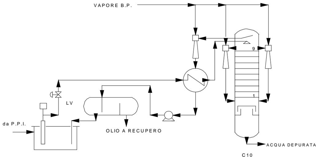
**Figura 7-5: Impianto tipo di strippaggio acque**
