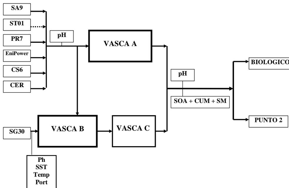
Figura 6-6: Schema semplificato della fognatura acida
