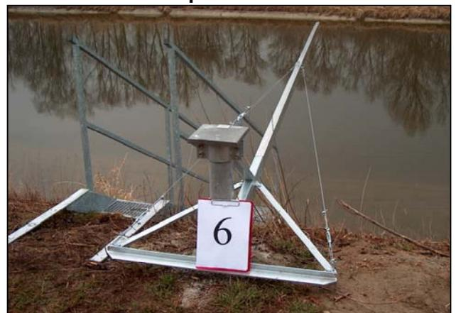
**Note:** Il cavo di controventatura è dotato di "tenditore" per la regolazione dell'orizzontalità in conseguenza di eventuali dilatazioni termiche dei materiali impiegati
