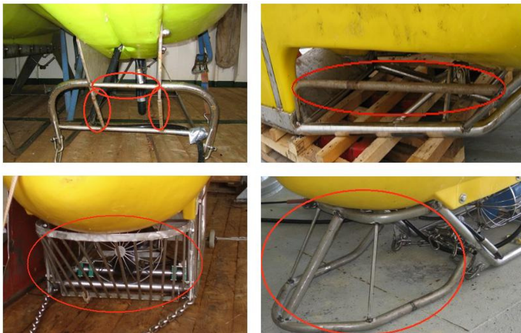
Figura 2.48 – Esempi di dispositivi metallici applicati alla struttura di sostegno della boa di coda che impediscono l'intrappolamento delle tartarughe (le parti aggiunte all'originaria struttura sono cerchiare in rosso). Fonte: Ketos Ecology report, 2009.
