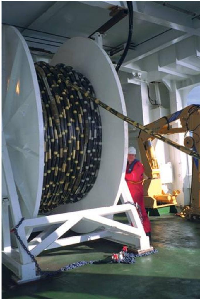
Figura 2.10 – Verricello con streamer avvolto
