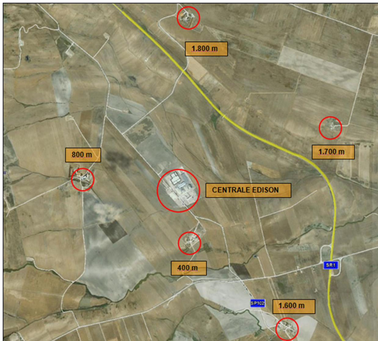
Figura 1 - Individuazione dei ricettori sensibili più vicini alla Centrale EDISON di Candela, con relative distanze dal confine della Centrale
