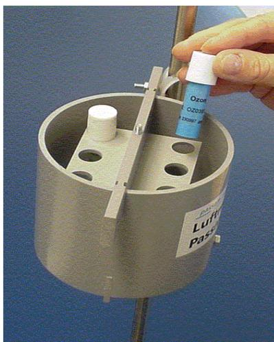
Struttura schematica del campionatore passivo per la misura dell'ozono ed espositore per l'impiego dei campionatori all'aperto
