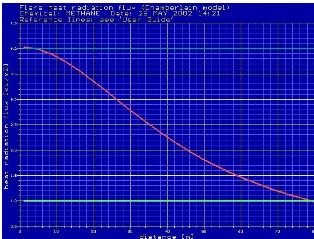
Figura 3: Andamento dell’Irraggiamento Termico (kw/m 2 ) dopo 5 s dall’istante del Rilascio – Jet-Fire da Rilascio Metano
