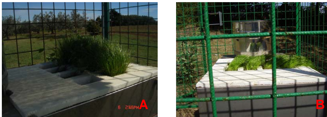
Figura 21 Esempio di biosensore utilizzato ( Lolium italicum var. multiflorum ) per il monitoraggio dei metalli pesanti
