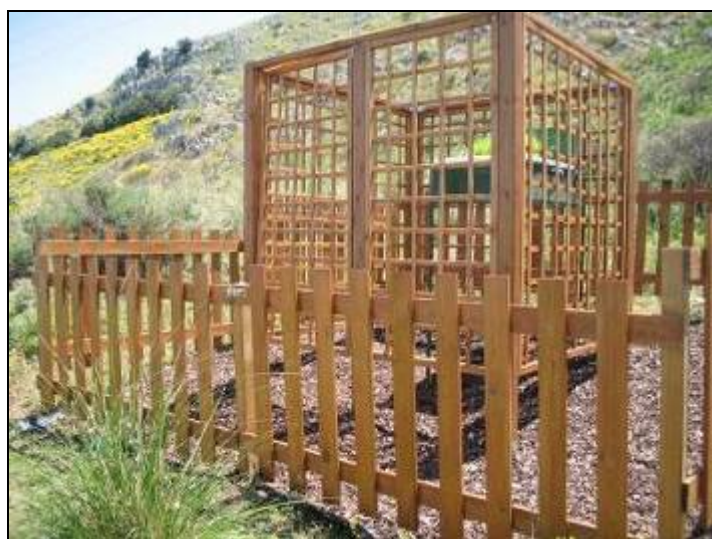
Figura 1-Gabbiotto per l'alloggiamento dei biosensori vegetali attivi (a sinistra con struttura in legno, a destra con struttura in ferro)
