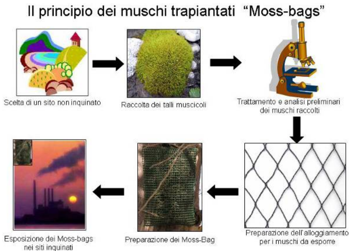
Figura 24 Disegno schematico del principio di funzionamento del monitoraggio attivo mediante trapianti
