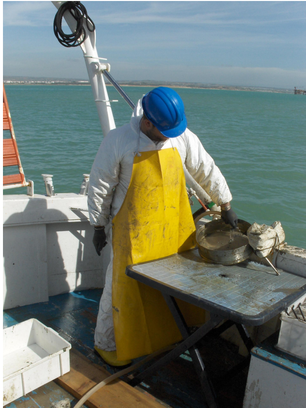
Foto 5 – Particolare della setacciatura del campione per analisi benthos
