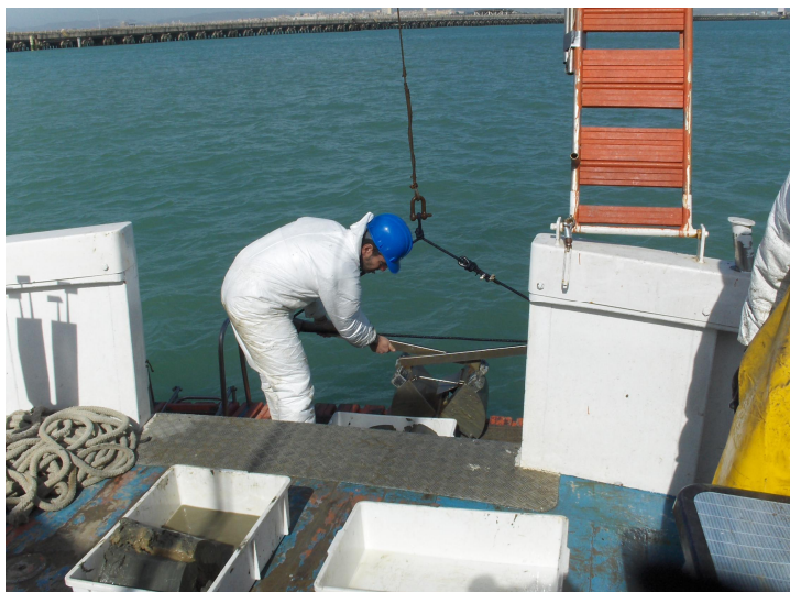
Foto 4 – Particolare del campionamento sedimenti mediante benna Van Veen
