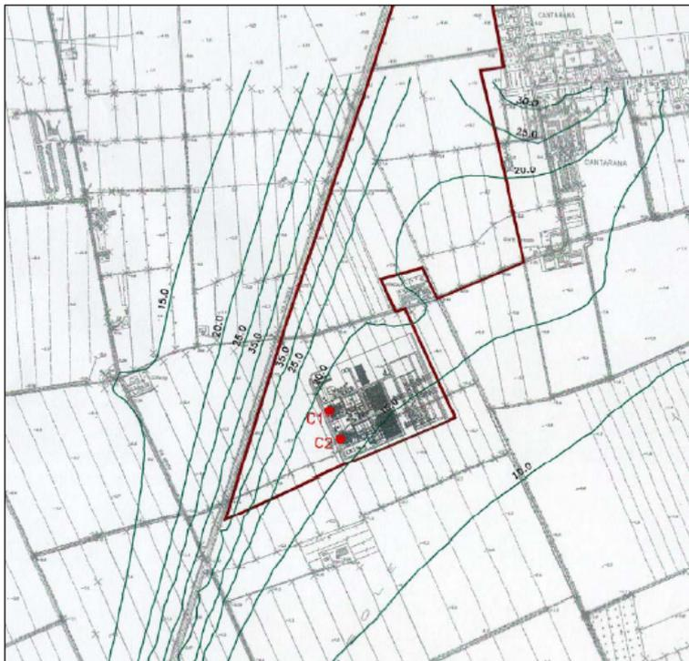
Figura 3 - Concentrazioni medie annue di CO attese al suolo al 2010 a seguito dell'esercizio della Centrale
