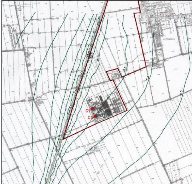
Figura 2 - Concentrazioni medie annue di NOx attese al suolo al 2010 a seguito dell'esercizio della Centrale.
