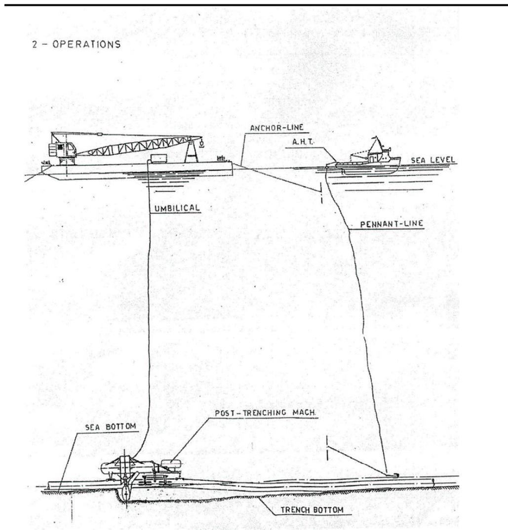
Figura 4.4c *Macchina di Post-Trenching*
