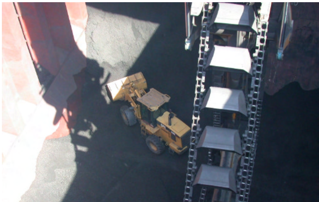
Figura 5: Bulldozer in azione per la pulitura finale della stiva
