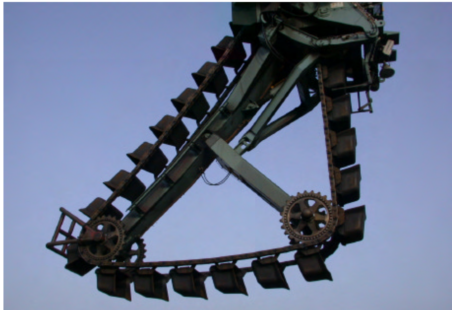
Figura 2: Esempio di piede a catena di tazze con articolazione a profilo triangolare
