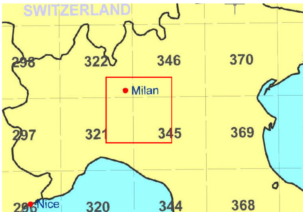
Figura 1. Schema delle tavole di dati MM5 con lato di circa 120 km e risoluzione dati di 12x12 km. In rosso è evidenziato l'area di 100x100 km centrata sull'impianto.
