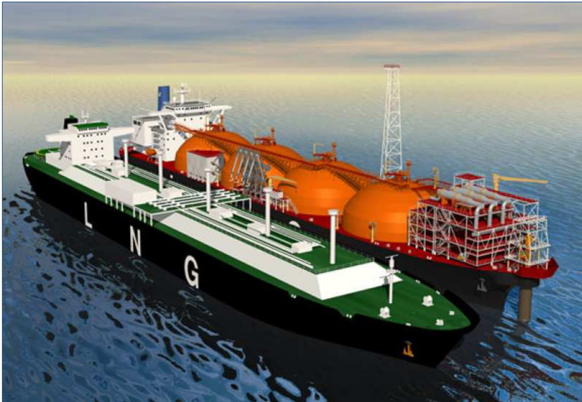
Figura 3.1 - Ormeggio della nave metaniera al Terminale
