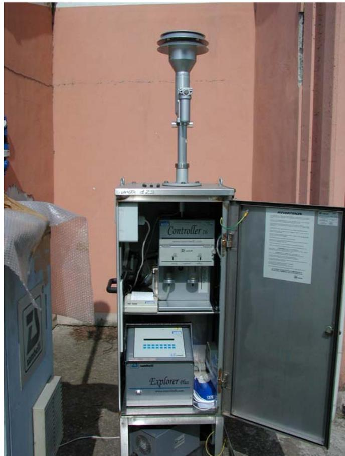
Figura 2 – Analizzatore/campionatore sequenziale di PM
