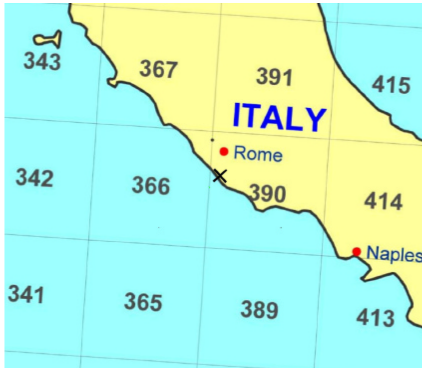
Figura 1. Schema delle tavole di dati MM5 con lato di circa 120 km e risoluzione dati di 12x12 km. La croce nera identifica la posizione dell'impianto.
