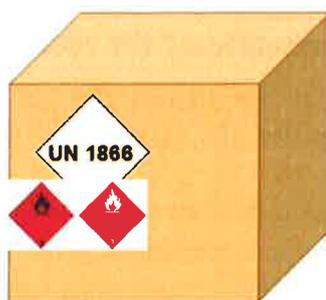
Fig 2: esempio di etichettatura e marcatura colli in esenzione parziale
