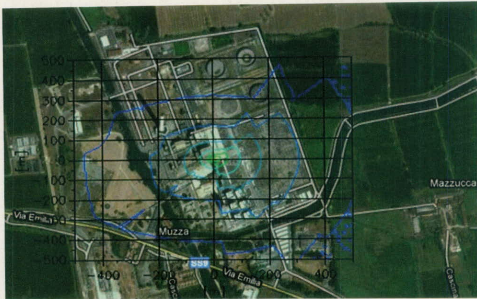
Figura 12.2: Curve isofoniche nel dominio piano prodotte dall'impianto
