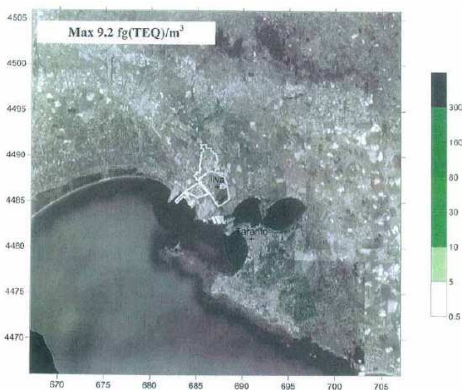
Figura 23. Dettaglio delle concentrazioni al suolo medie annue di diossine su un'area di 15 \times 15 \text{ km}^2 centrata sullo allo stabilimento ILVA. Valori in \text{fg(TEQ)/m}^3 secondo la scala colorata riportata a destra del grafico
