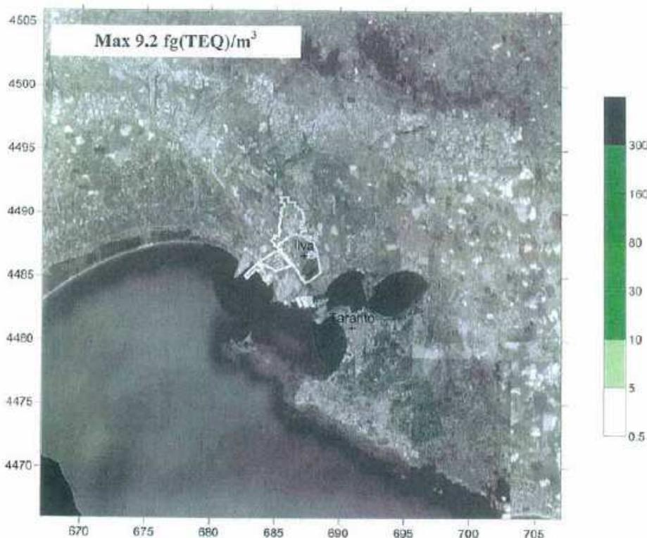
Figura 23. Dettaglio delle concentrazioni al suolo medie annue di diossine su un'area di  $15 \times 15 \text{ km}^2$  centrata sullo allo stabilimento ILVA. Valori in  $\text{fg(TEQ)/m}^3$  secondo la scala colorata riportata a destra del grafico
