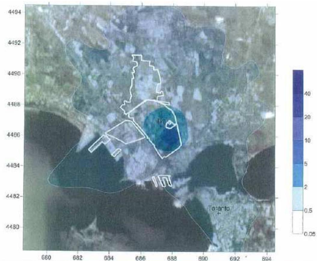
Figura 31. Dettaglio della mappa di deposizione totale al suolo medie annue di diossine su un'area 15x15 km<sup>2</sup> centrata sullo stabilimento ILVA. Valori in pg(TEQ)/(m<sup>2</sup> giorno) secondo la scala colorata riportata a destra del grafico
