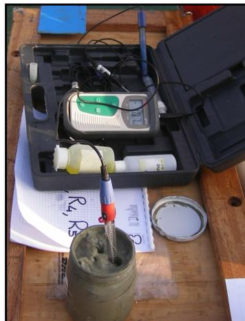
**Figura 2.4** - Strumentazione utilizzata per la misura di Temperatura, pH e Potenziale Redox nel sedimento campionato. A sinistra: sonda PH 6 XS; a destra: prime misure in campo del sedimento campionato.
