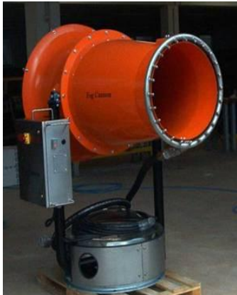
Figura 11: esempio di fog cannon e aree di efficacia per varie taglie di apparecchiatura
