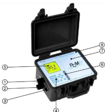
1. Connettore per sensore "Air – ultrasonicactive"
