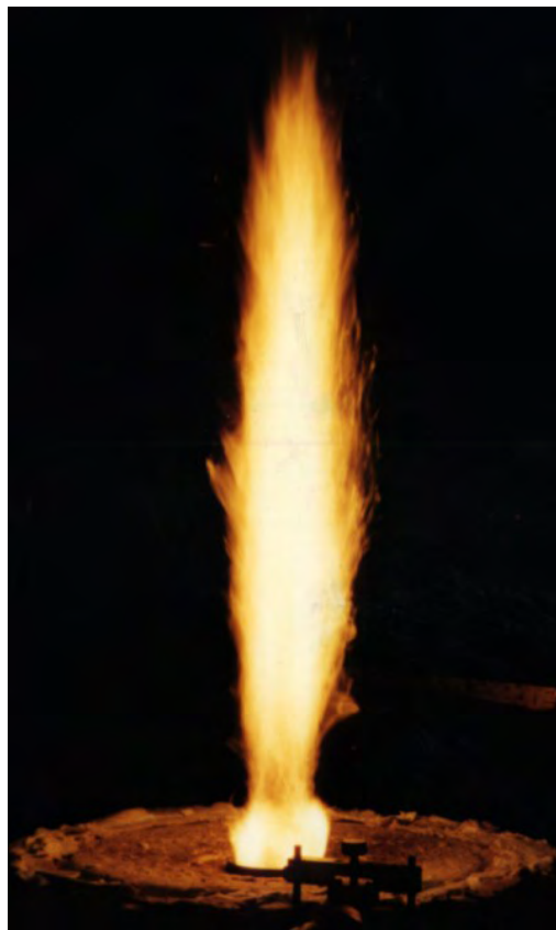
Fig. 4.1. Struttura di fiamma tipica ottenuta con il bruciatore TEA
