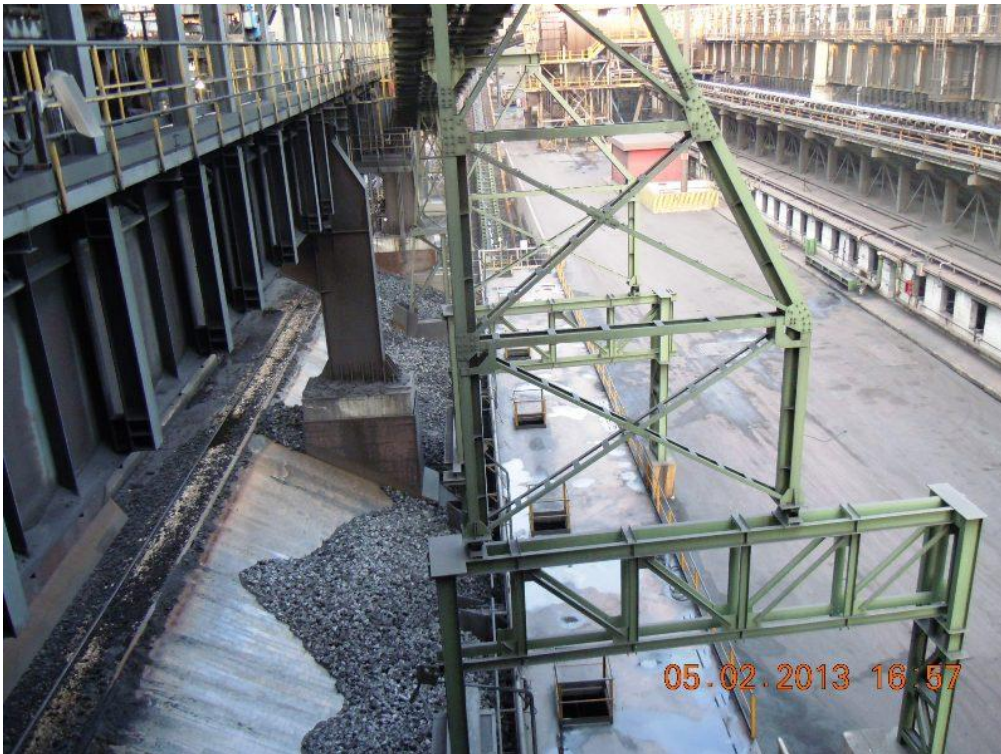
Foto Batteria XII Rampa di scarico n°7 sovrastata dal nastro trasportatore NF/2
