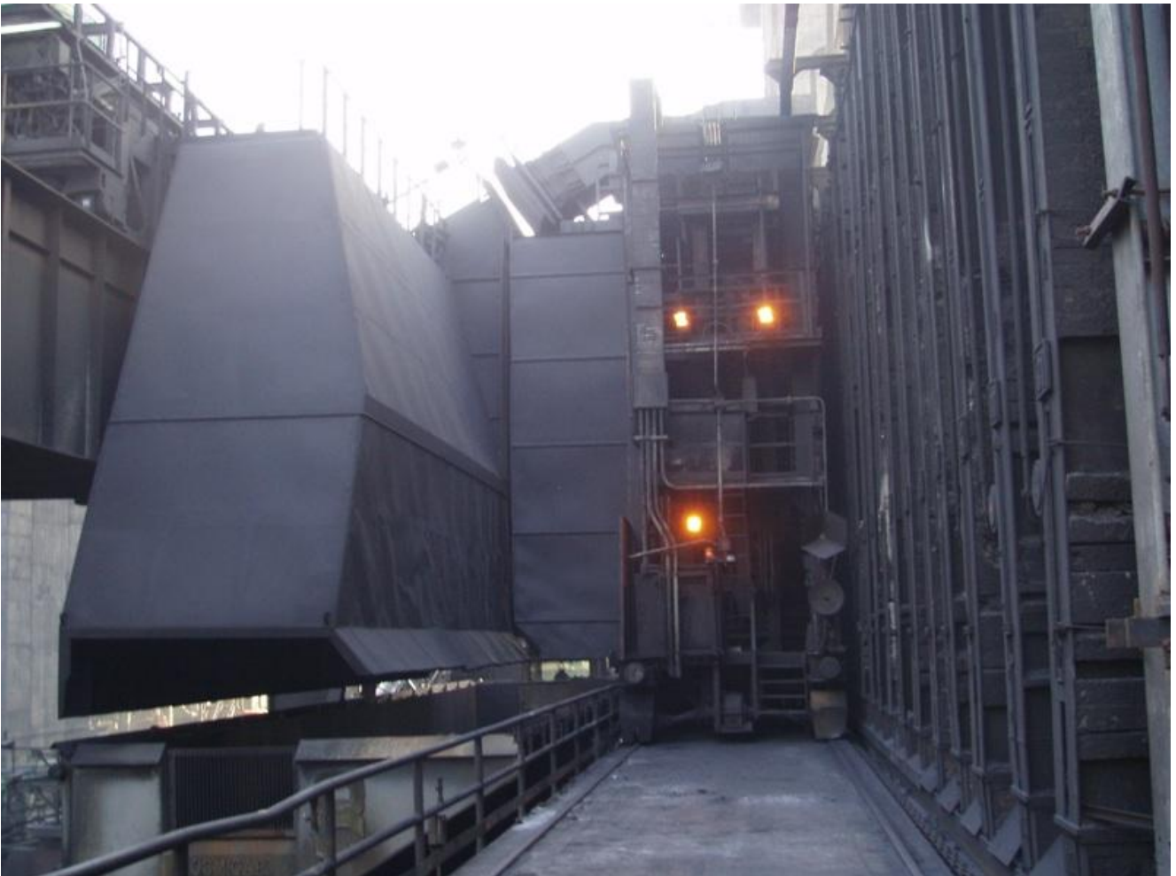
Foto " TIPICO " sistema di sfornamento attuale composto da guida coke, carro coke e cappa di aspirazione fumi.
