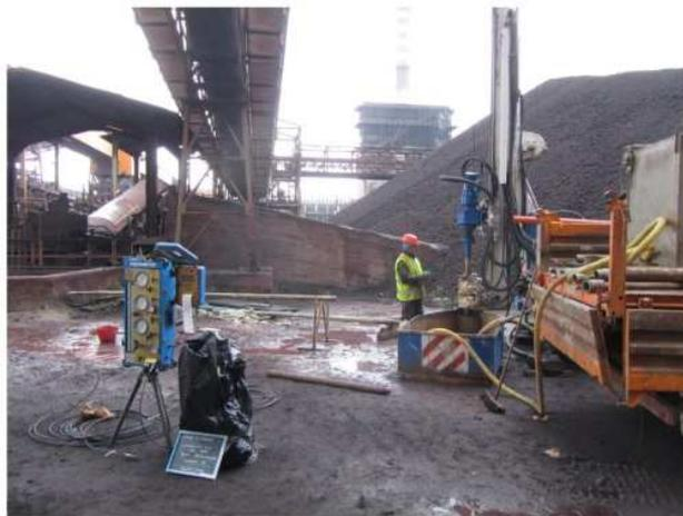
Fig.2.2.5 a Fasi di esecuzione delle prove pressiometriche nel foro di sondaggi S1 Parco AGL NORD
