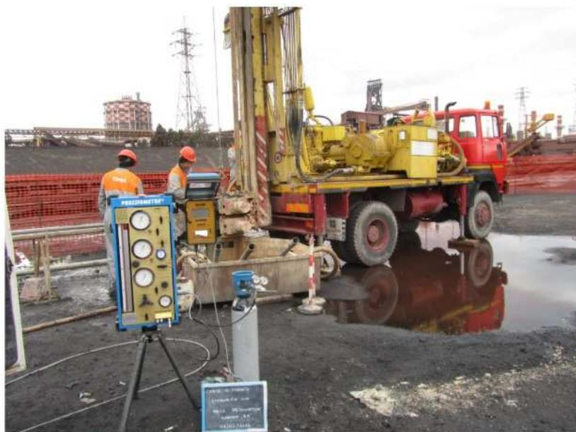
Fig. 2.2.5.f Fasi di esecuzione delle prove pressiométriche nel foro di sondaggi S4 Parco OMO
