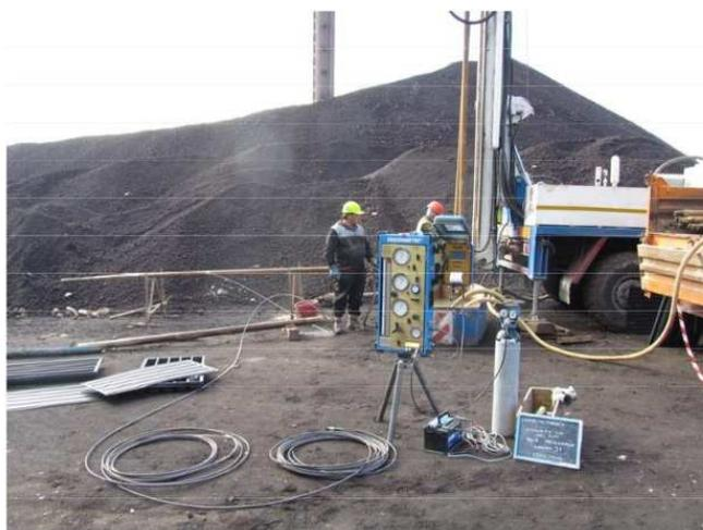
Fig.2.2.5.d Fasi di esecuzione delle prove pressiométriche nel foro di sondaggi S1 Parco AGL SUD
