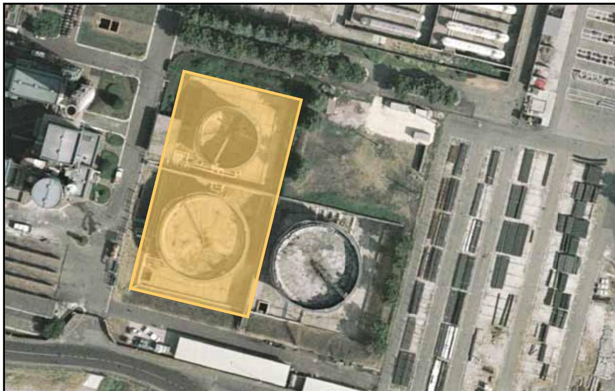
**Figura 2** Zona dei serbatoi di stoccaggio dell'olio combustibile esistenti. In giallo la porzione dell'area che sarà utilizzata per la realizzazione del nuovo fabbricato per l'allocazione di tre nuove caldaie.
