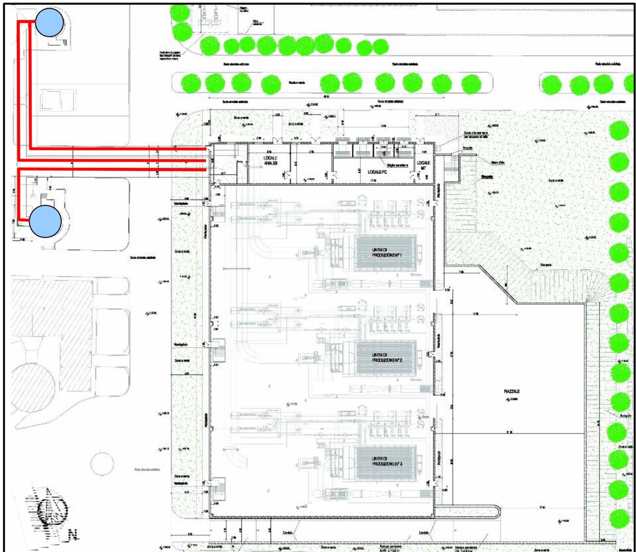
**Figura 3** Nuovo fabbricato generatori di calore, disposizione delle unità produttive. Le linee rosse indicano le tubazioni di scarico fumi dei generatori limitatamente alla porzione che si sviluppa all'esterno del nuovo edificio sino all'imbocco del camino. In azzurro i camini Nord e Sud.
