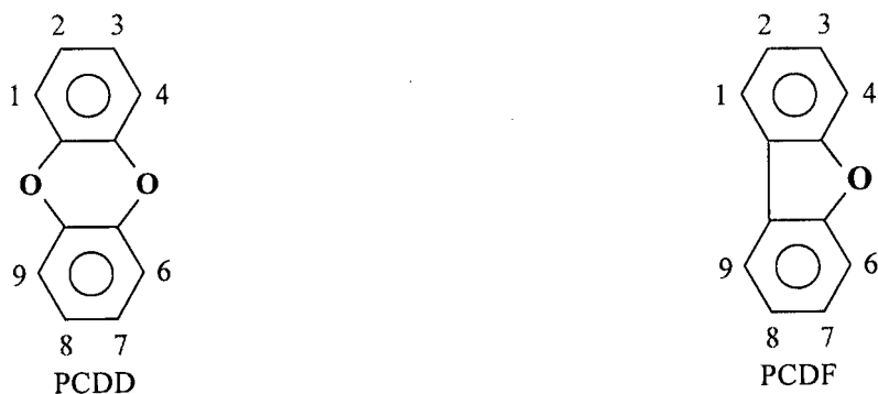
Figura 3 - Formule di struttura di diossine. I derivati del cloro più tossici sono gli isomeri con almeno 4 atomi di cloro nelle posizioni 2,3,7,8.
