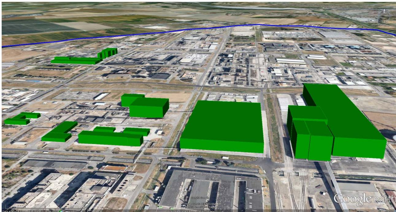
*Figura 3-I Strutture potenzialmente responsabili del building downwash dell'impianto esistente*
