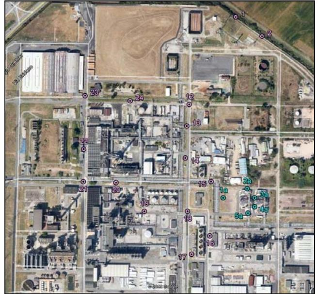
Figura 5.2 – Ubicazione dei punti oggetto di indagine fonometrica all'interno dello stabilimento (impianti GP26 e Off-Gas)
