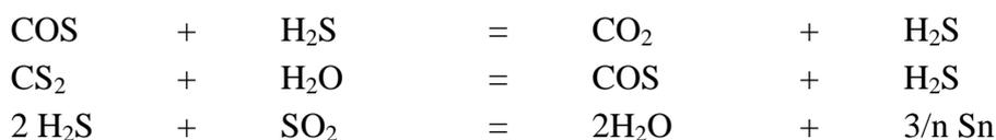
Tutte e tre le reazioni sono esotermiche. La temperatura del gas di processo in uscita dal reattore è circa  $320^\circ\text{C}$ .
