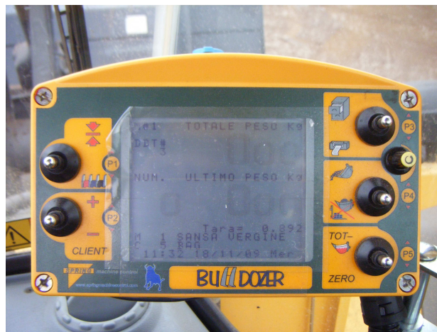
Display della cabina di guida per la rilevazione del peso da parte del palista
