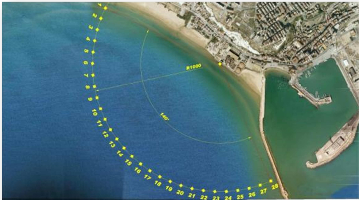
Figura 2 - Inquadramento della centrale termoelettrica di Porto Empedocle e arco a 1000 m con la numerazione delle stazioni di misura della temperatura (fonte Google Earth).
