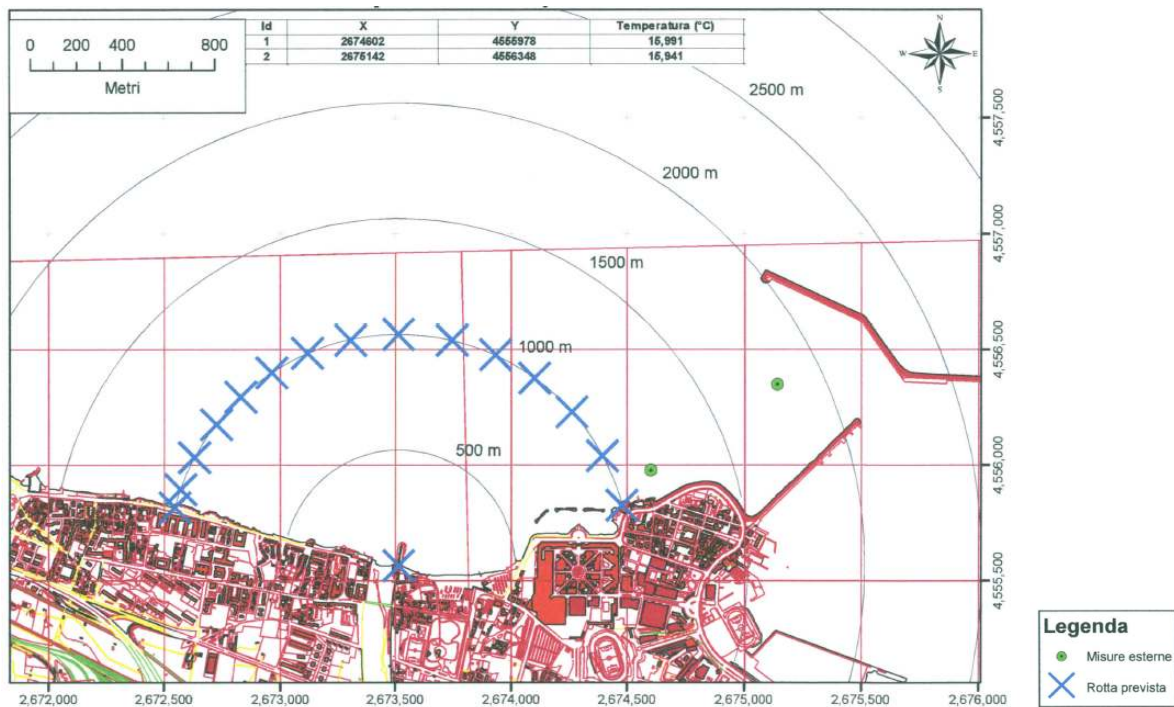
Figura 2: Rotta prevista per la determinazione dei valori di temperatura esterni all'area di interesse a 10 cm dal pelo dell'acqua.
