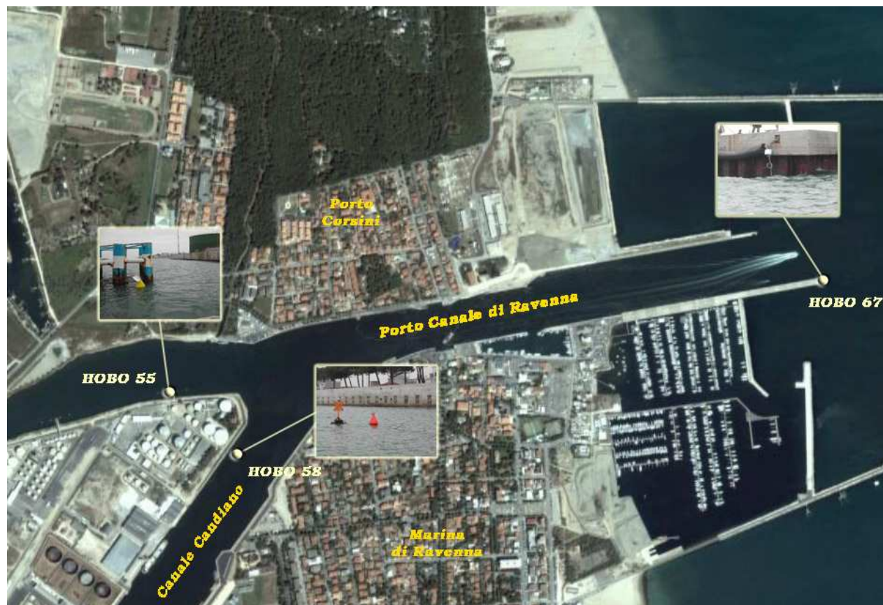
Fig. 6 - Schema della rete termografica installata - Particolare zona molo
