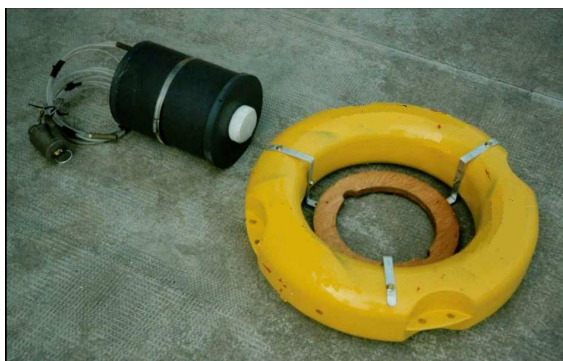
Fig. 13 - Termografo a 3 punti di misura
