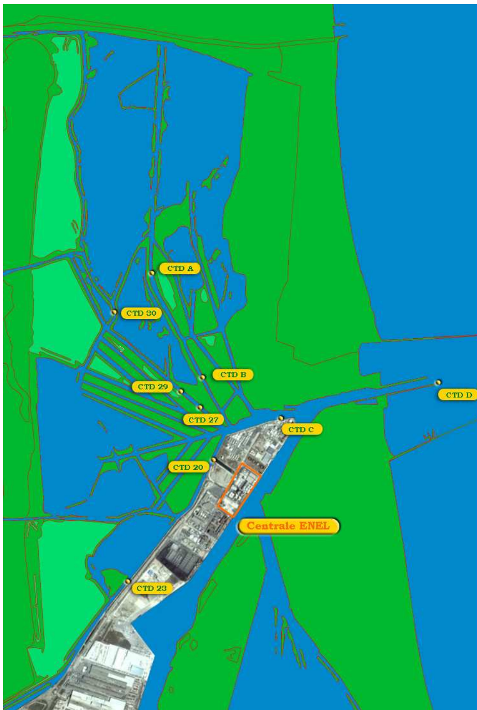
Fig. 7 - Planimetria della Pialassa Baiona con indicata l'ubicazione delle 9 stazioni di misura della temperatura tramite sonda CTD
