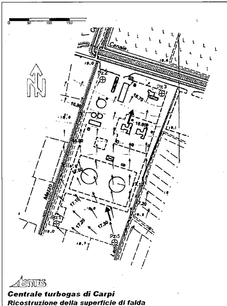
Figura 5 - Ricostruzione della superficie di falda e dell'andamento prevalente. Misure del 19/05/2010.
