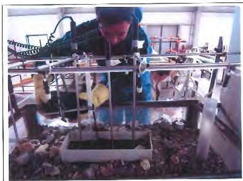
Figura 31 - Sversamento dei primi due litri di OCD all'interno della vaschetta di contenimento durante la fase di sperimentazione in condizioni umide.
