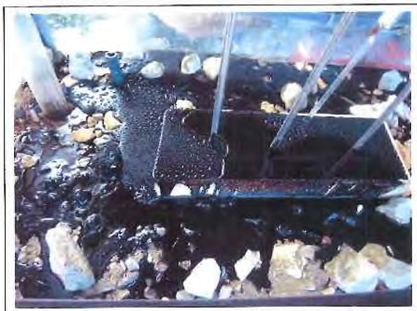
Figura 34 - Formazione di ristagni d'acqua sulla superficie dell'OCD dopo la prima simulazione di pioggia.
