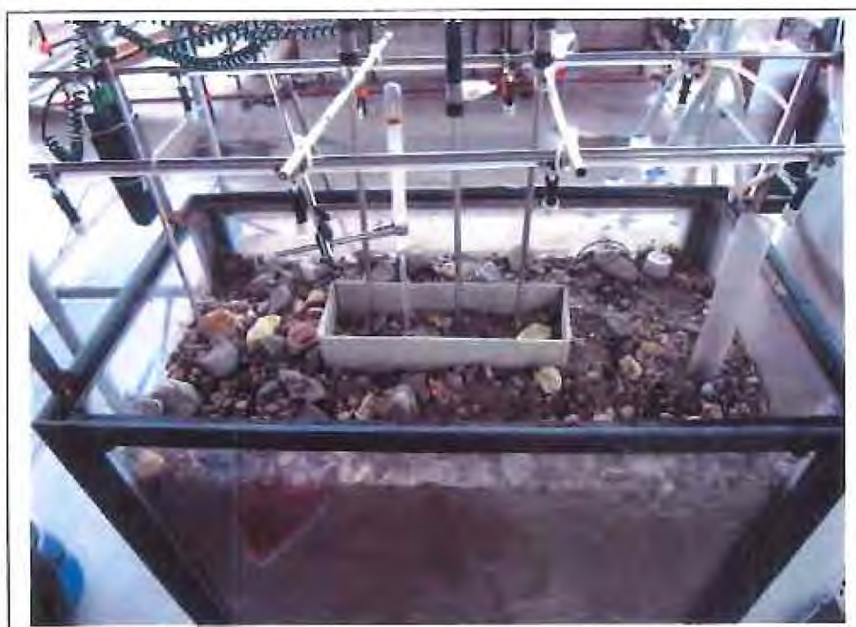
Figura 30 - Vista dall'alto dell'impianto dotato di sistema di irrorazione acqua e della vaschetta di contenimento.
