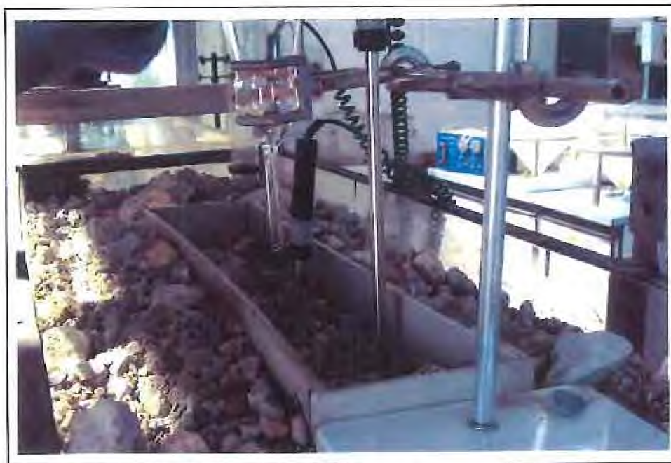
Figura 23 - Vaschetta di contenimento per prove di sversamento OCD su terreno ricostruito in condizioni climatiche secche.
