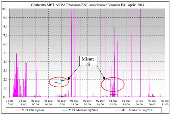
Come è possibile osservare dai tracciati si evidenzia una scarsa corrispondenza tra le misure di ARPAT e quelle determinate dallo SME del Gestore. Tutte e 6 le determinazioni gravimetriche effettuate da ARPAT sono maggiori di quelle registrate dallo SME mediante la strumentazione automatica. La differenza osservata è grande in termini relativi ma molto piccola in valore assoluto, infatti la misura più grande di ARPAT non supera i 2 mg/Nm3 rif al 3% di O2.
