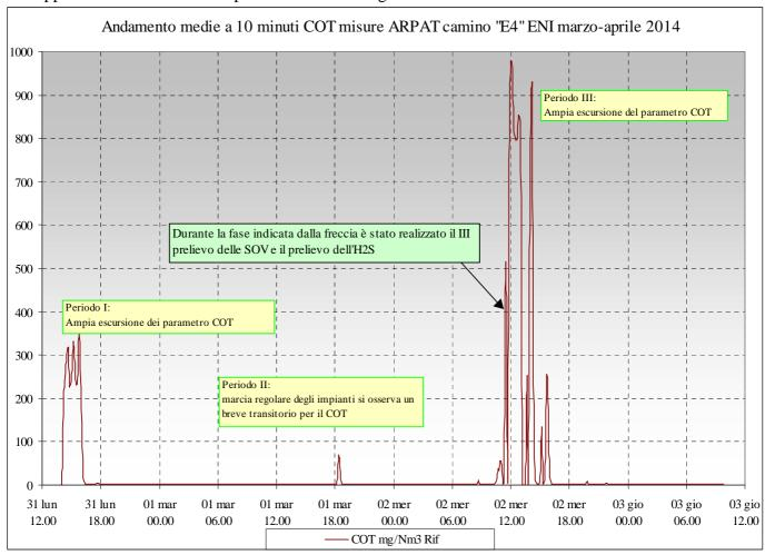
Come è possibile osservare nella figura sopra esposta, all'inizio delle misure di ARPAT il 31 marzo e alle ore 11.30 (solari) del 2 aprile fino alle 17.00 circa dello stesso giorno, si sono verificati due importanti eventi che hanno causato un significativo aumento del COT alla emissioni "E4".
