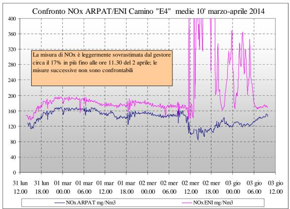
Dalla figura qui sopra si evince che fino all'avvento di alcune particolari anomalie agli impianti che generano la messa in aria al Camino E4, le misure del gestore sovrastimavano la concentrazione di NOx di circa il 17%, rispetto alla concentrazione di questo inquinante come rilevato dalla strumentazione di ARPAT.
