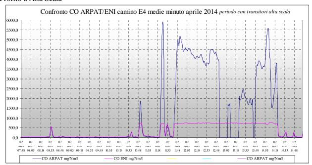
Le due figure qui sopra illustrano con scale di concentrazioni differenti lo stesso periodo di misure. Si osserva molto bene che le misure di CO del Gestore, sono leggermente sovrastimate alle basse concentrazioni (figura in alto) e, al contrario, molto sottostimate come nel caso illustrato, quando viene raggiunto il fondoscala dello SME stesso ( si veda anche le figure di pagina 22)
