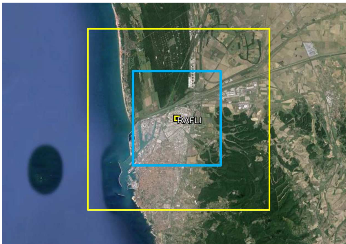
Figura 3 - Individuazione del dominio di calcolo per la dispersione pari a 6 km x 6 km (blu) interno al dominio meteorologico (giallo) di estensione pari a 12 km x 12 km.
